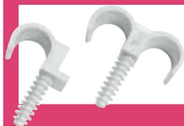
Afin de fixer le tube pré-gainé (simple ou double) sur la dalle béton, utiliser les colliers plastique FIXATUB (voir p. 85), à raison d'un collier tous les mètres en moyenne.
