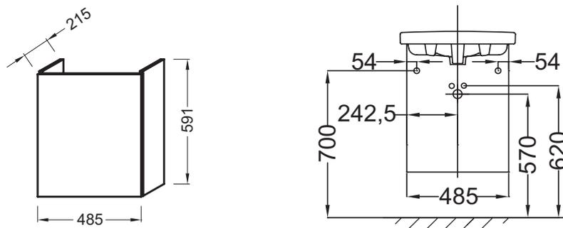
Description : Meuble sous lave-mains compact 50 cm. EB863. Collection : ODÉON UP. Dimensions : 48,5 x 21,5 x 59,1 cm. Poids : 9 kg. Matériau : Mélaminé. Installation : Suspendu. Rangement : 1 porte réversible à fermeture progressive. ROBINETTERIE RECOMMANDÉE : Robinetterie Aleo, une gamme design très accessible. Cette collection ne fait pas partie du programme "laque à la carte".
