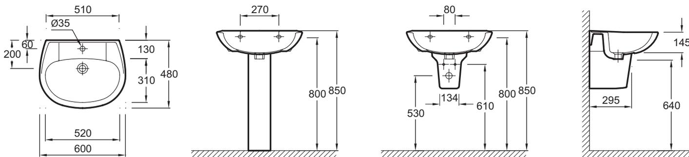
Description : Lavabo 60 x 48 cm sans trou de trop-plein. E1288F. Collection : BRIVE. Dimensions : 60 x 48 cm. Poids : 13,9 kg. Matériau : Céramique. Installation : Autoportant. Percement robinetterie : Percé 1 trou. Fixations : 3 types de fixations possibles : Goujons, consoles ou crochets. Sans trou de trop-plein. OPTIONS : Colonne, cache-siphon.
